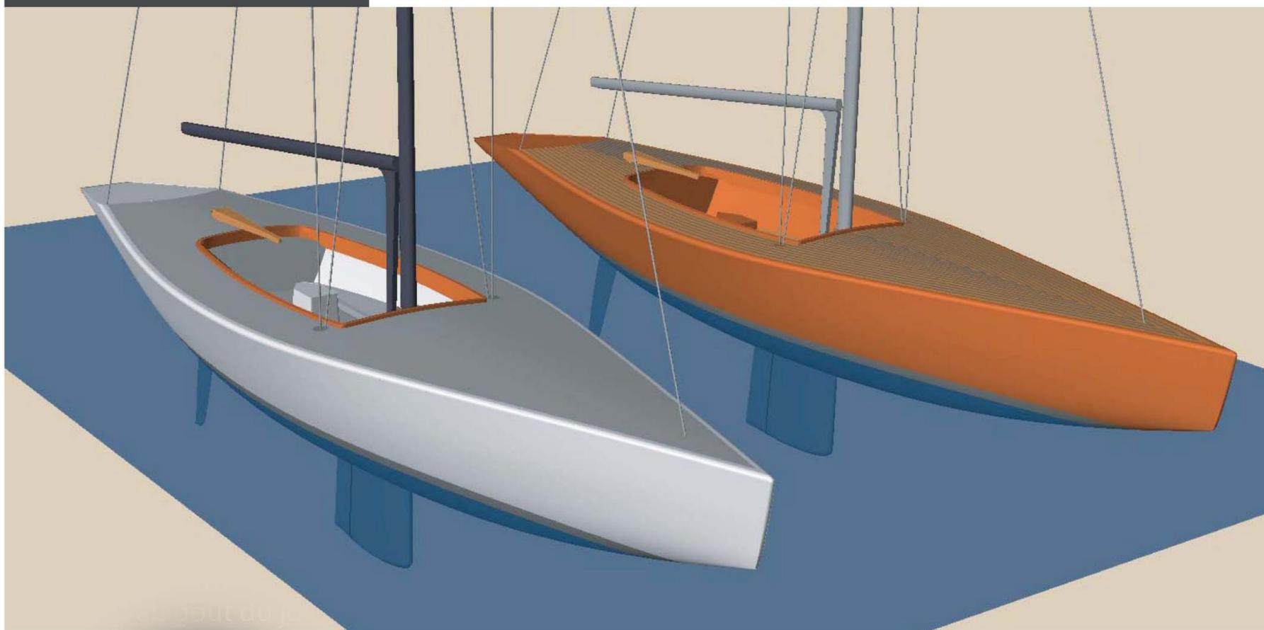
*Der neueste Riss der 15m<sup>2</sup>-SNS ist das Ergebnis der jüngsten Erkenntnisse aus dem America's Cup einerseits und dem Design der neuesten und aktuellsten Rennyachten andererseits. Aus formverleimten Holz mit dem ausgewiesenen Know-how der Werft Burkhalter hergestellt, ist die Yacht in verschiedenen Ausführungen erhältlich und zudem mit einem selbstlenzenden abgedichteten Cockpit ausgestattet, welches der Europäischen Norm 94/25/CE entspricht.*
