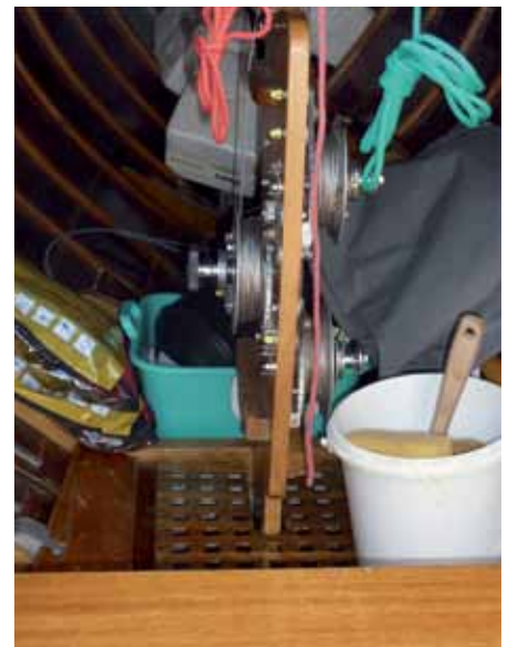
17 - Vertikales Fallenbrett unter Holz-mast. Kabel-Fallen laufen im Mast.
